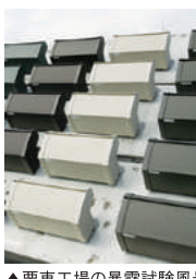
▲栗東工場の暴露試験風景(南面35°傾斜)
