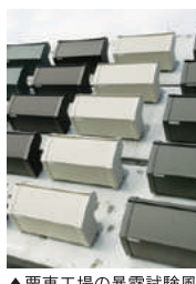
▲栗東工場の暴露試験風景(南面35°傾斜)
